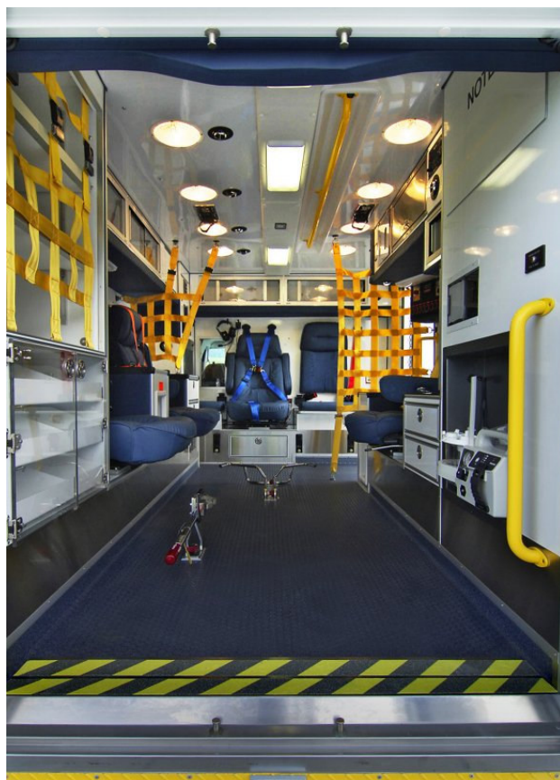
Figuras 3, 4 y 5. Sistemas de anclaje y protección en el habitáculo asistencial (tomado de Sides et al 12 ).
